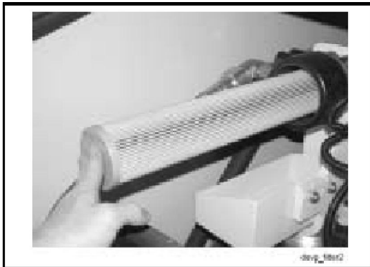
Рисунок 8.13: Удалите использованный и вставьте новый элемент в корпус фильтра
