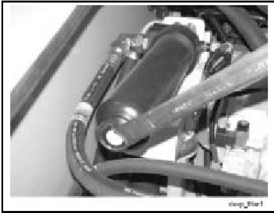
Рисунок 8.12: Отверните корпус фильтра поворотом против часовой стрелки с помощью ключа 41 мм
