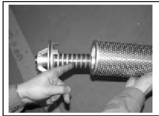
Рисунок 8.19: Очистите магниты перед установкой нового фильтра (смотри рисунок 8.20). Затяните крепление элемента с моментом 20-25 Нм. Установите элемент на место и закройте крышку
